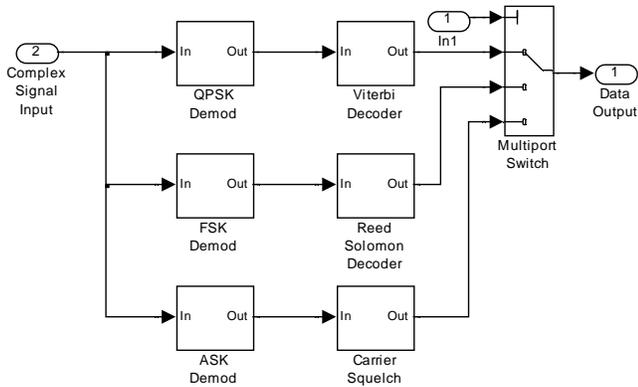
**Figure 2. Parallel Multi-Mode Waveform Model.**
